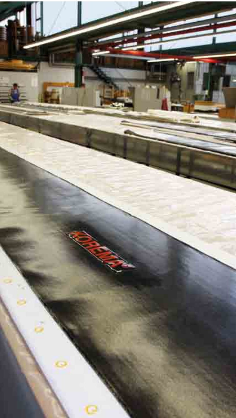
带式膨胀节的制造
